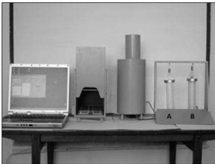
Ryc. 1. Komputerowe stanowisko pomiarowe do oceny funkcji ręki. Dokładność pomiarów czujników wykorzystanych do pomiarów komputerowych wynosiła \pm 0,1 % dla czujnika ciśnienia - A i \pm 0,2 % dla czujnika przemieszczenia - B (pomiaru zakresu ruchu) [11].
