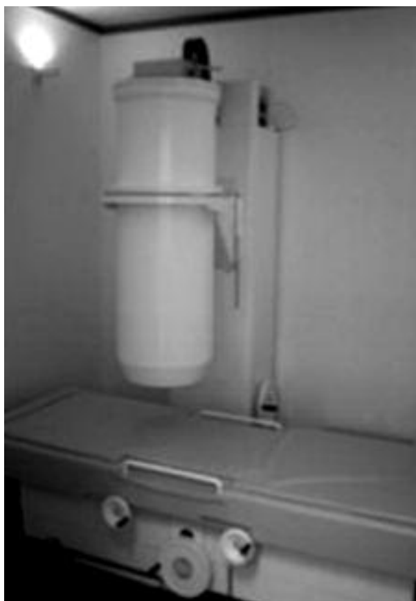
Fig. 2. Assembly of Dewar, held by the gantry, and the bed Ryc. 2. Naczynie Dewara zamontowane na ramie oraz łóżko
